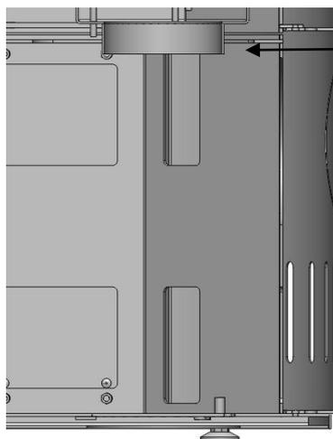
Détail buse de raccordement
